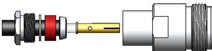
5) Introduzir o pino soldado no cabo no conector, e colocar o kit para fixação do cabo.
