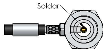
3) Introduzir o cabo no conector ate enconstar o condutor central no pino e soldar.
