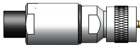
4) Introduzir o condutor central no contato do corpo, e rosquear a capa, e dar aperto final com chave.
