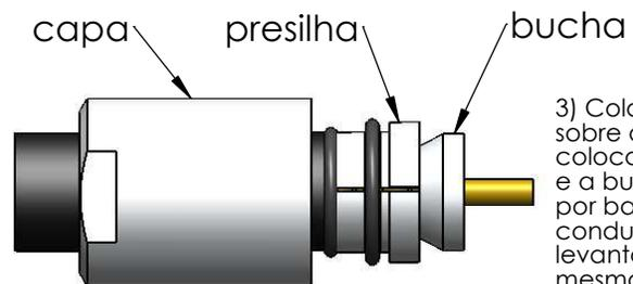
3) Colocar a capa sobre o cabo, colocar a presilha e a bucha cônica por baixo do condutor externo levantando o mesmo até encostar na presilha.
