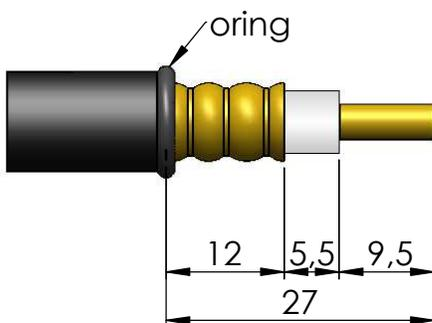
2) Cortar o cabo conforme figura e introduzir oring.
