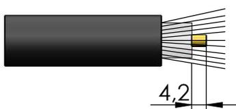
2) Abrir a malha e cortar o dielétrico expondo o condutor central 4,2mm.
