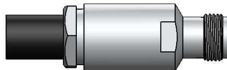
6) Introduzir o cabo com os componentes no conector e apertá-lo usando chaves apropriadas.
