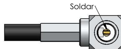
3) Introduzir o cabo no conector até encostar o condutor do cabo no fresado do conector e soldar.
