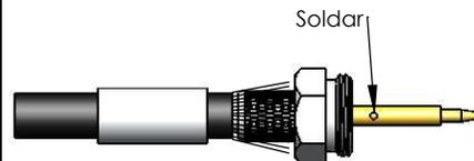
3) Introduzir o condutor do cabo no pino, e soldar. Colocando a malha sobre a parte recartilhada do redutor.
