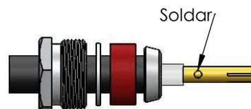
4) Introduzir o pino no condutor central, encostá-lo no dielétrico e soldar. Evitar excesso de calor para não deformar o dielétrico.
