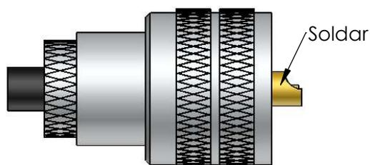
3) Introduzir o cabo no conector e rosquear até o condutor central aparecer na área fresada do pino. Soldar o condutor do cabo no pino.
