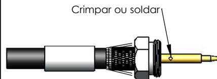
3) Introduzir o condutor do cabo no pino, e crimpar ou soldar. Colocando a malha sobre a parte recartilhada do redutor.
