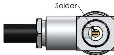
4) Empure o conector no cabo até que o condutor do cabo fique sobre o fresado do contato do conector. Soldar o condutor.
