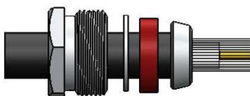
2) Fechar a malha e introduzir no cabo o redutor, arruela, anel de vedação e a bucha sobre a malha encostando na capa de vinil.
