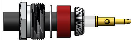
4) Introduzir o pino no condutor central, encostá-lo no dielétrico e soldar. Evitar excesso de calor para não deformar o dielétrico.
