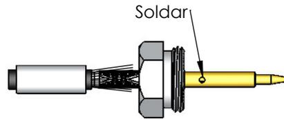
3) Introduzir o condutor do cabo no pino, e crimpar ou soldar. Colocando a malha sobre a parte recartilhada do redutor.
