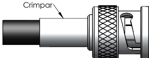
5) Colocar a bucha sobre a malha até encostar no conector e crimpá - la.
