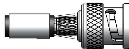
4) Introduzir o pino soldado no conector colocando a malha sobre a parte recartilhada do conector.
